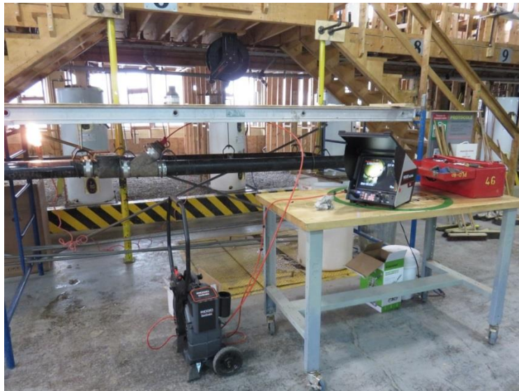
Figure 4-6 : Caméra d'observation en aval du clapet
