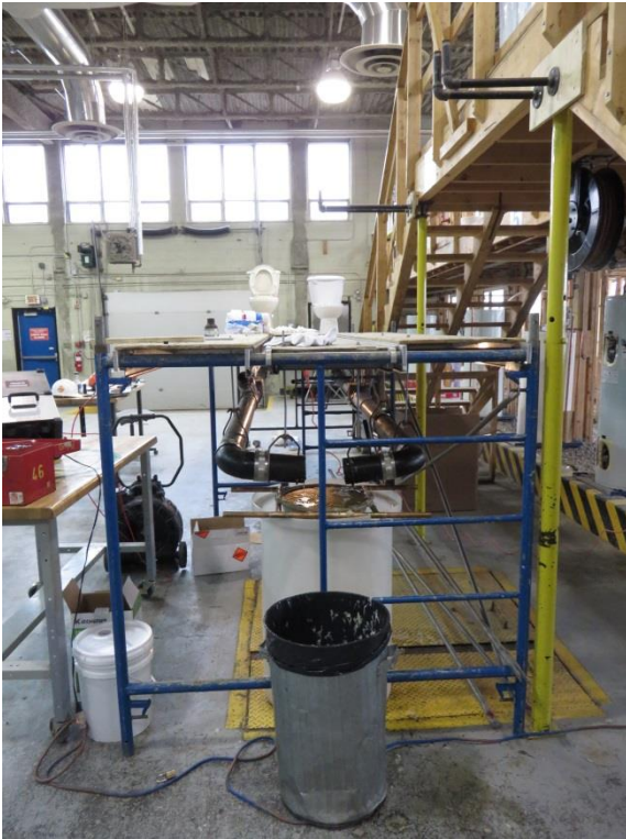
Figure 4-2 : Bassin de captage et tamis
