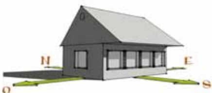
La construction solaire passive Le côté long de la maison est orientée selon l'axe est-ouest, avec un maximum de fenêtres du côté sud.
